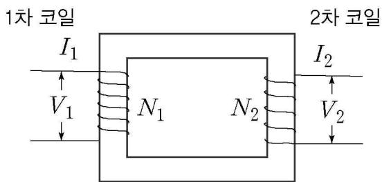
1차 코일에 전압 1000V, 전류 1A가 공급된다면 2차 코일에서 출력되는 전압( $V_2$ )과 전류( $I_2$ )는 각각 얼마인가? (단, 에너지 전환과정에서 에너지 손실은 무시한다.)
